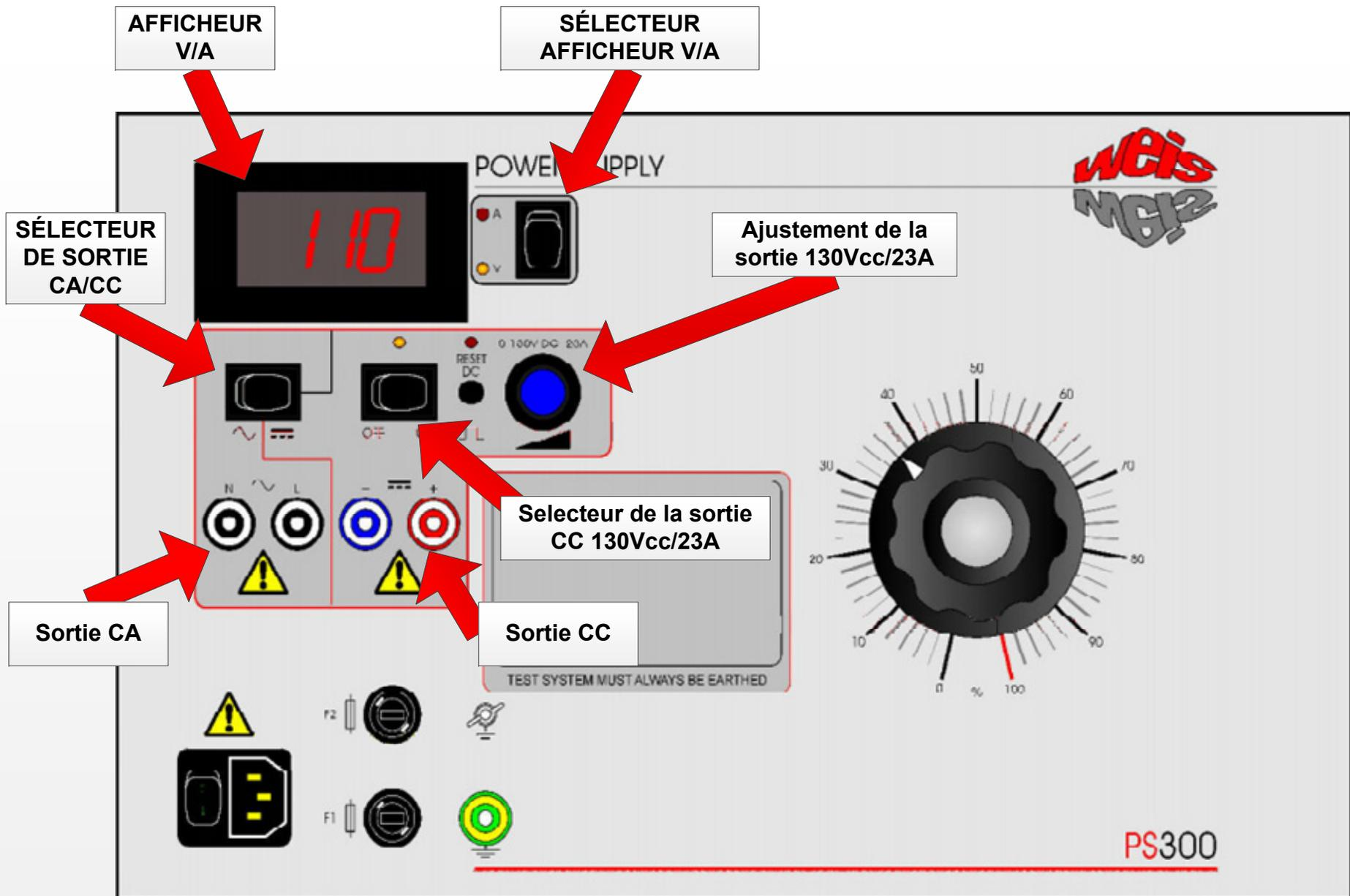
**Pour obtenir des décharges rapides du circuit CC il suffit de placer l'interrupteur principal en position OFF pour une brève période.**
