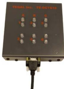
Placez les afficheurs à un endroit utile pour faire les ajustements requis. Les afficheurs sont dotés d'aimants puissants qui vous permettent une installation à la hauteur désiré.
