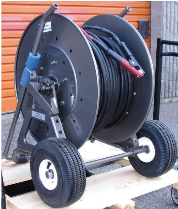
L'ensemble de câbles d'essais TEQAL modèle TE-CPA-xxx-xx est fabriqué pour une utilisation avec les micro-ohmmètres 200A pour les essais de la résistance des grilles de mise à la terre dans les postes électriques.
