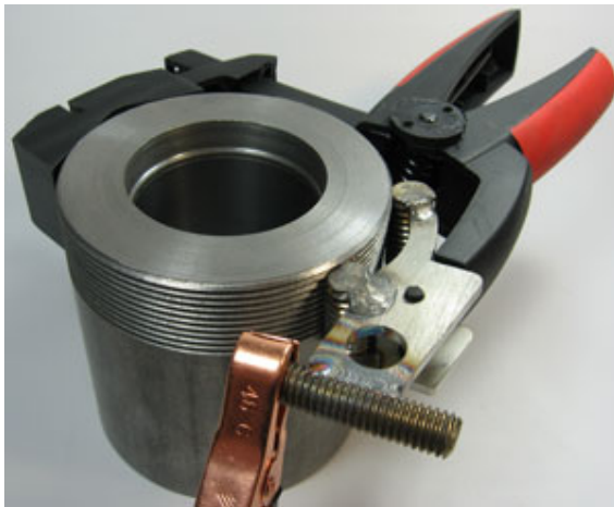
VariClip sur une pièce au diamètre de 3 1/2"
